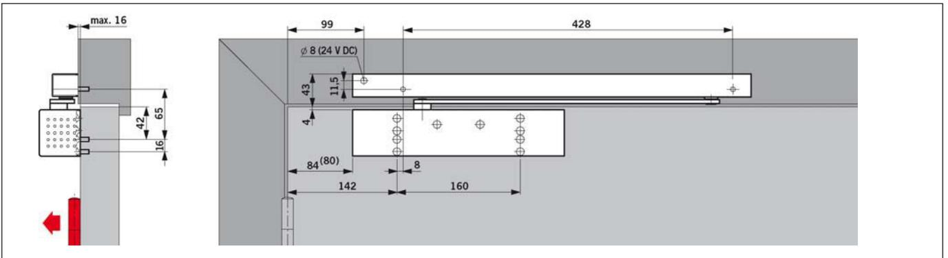
TS 93 B mit Gleitschiene DORMA G-EMR
