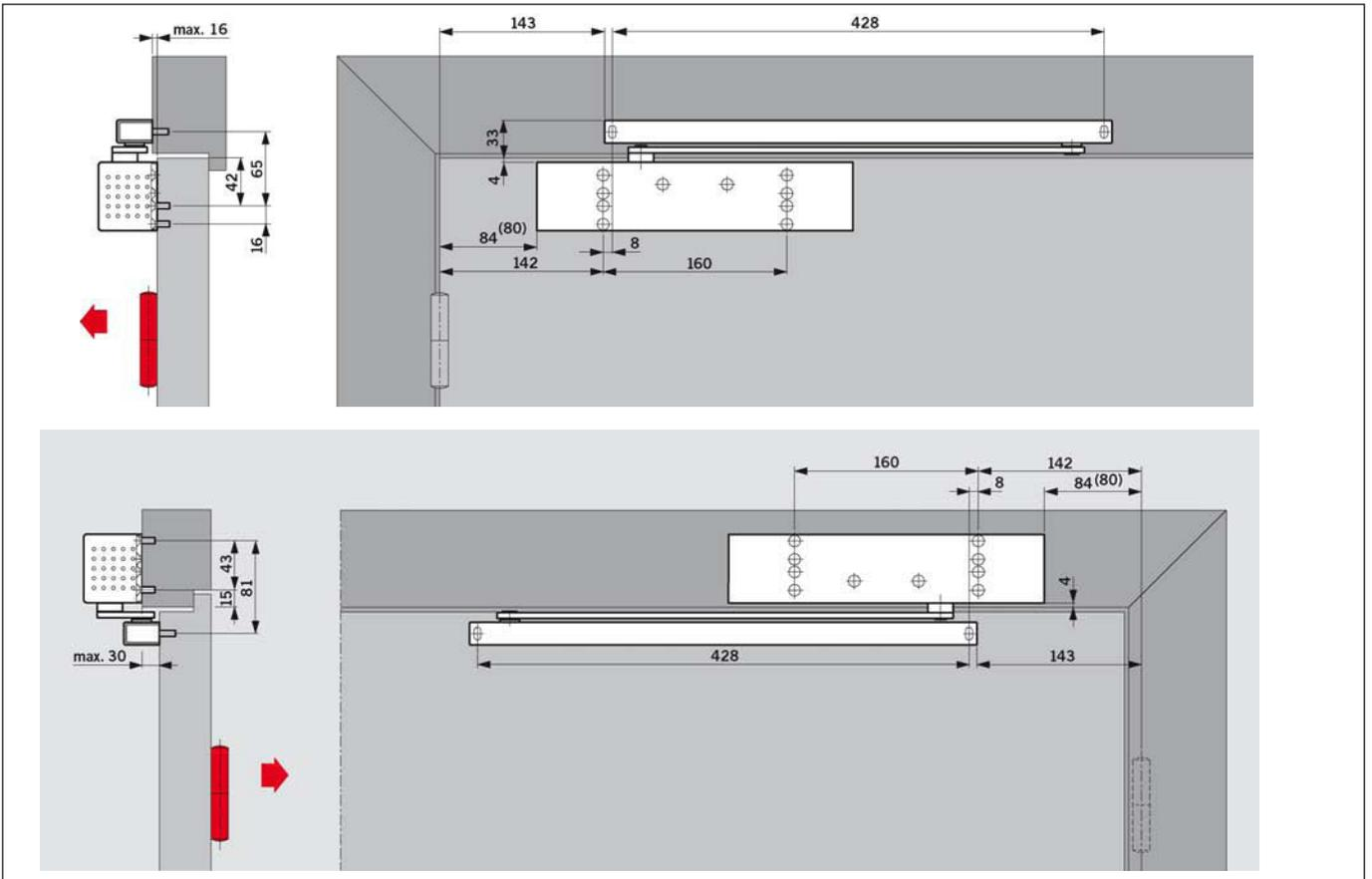
TS 93 B mit Gleitschiene DORMA G-EMF
